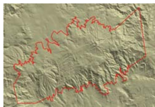
Archivo en formato TIN generado a partir de las curvas de nivel, utilizado para realizar el MDE.
